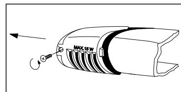
После замены лампочки установите на место крышку лампочки, завинтите винт и включите прибор в сеть.
